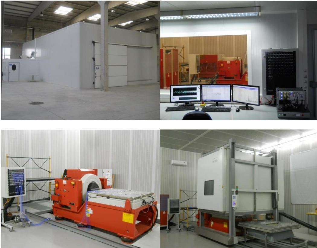
O **Sistema Shaker** LDS SPA176K de 105kN, pode chegar até 8 canais de controlo LDS e tem a possibilidade de monitorizar até 44 canais de resposta num sistema LMS, com acelerómetros disponíveis de 50g a 10000g uniaxiais e triaxiais. Permite efetuar a aquisição de dados de vibração para análise modal, entre outras opções.
