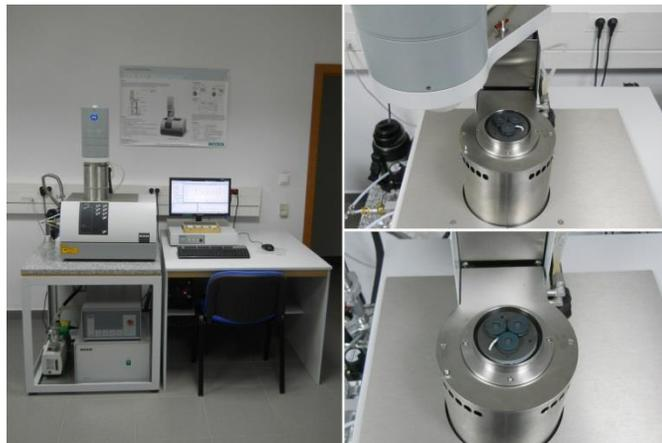
A **Dilatometria** permite a determinação do coeficiente de expansão térmica de diversos materiais com uma gama de temperatura compreendida entre os  $-150^{\circ}\text{C}$  a  $1550^{\circ}\text{C}$ . Incluem-se nos objetos já ensaiados a medição de valores em trabalhos de ID, indústria aeroespacial e outros.
