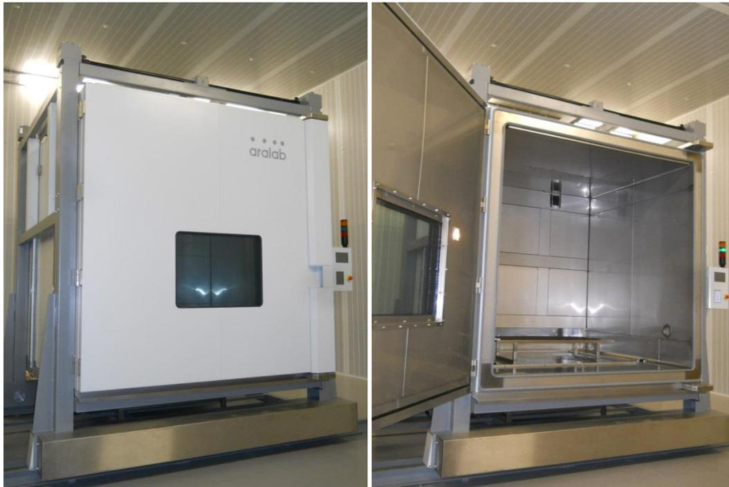
A **Câmara climática** permite definir programas até 50 segmentos distintos e criar um perfil de ensaio próprio. Inclui acessórios de apoio aos ensaios. Atinge temperaturas de funcionamento entre  $-45^{\circ}\text{C}$  e  $150^{\circ}\text{C}$  e humidade de 10 a 90%. De entre os ensaios já realizados incluem-se ciclos de envelhecimento a diversas amostras no âmbito da indústria aeroespacial.
