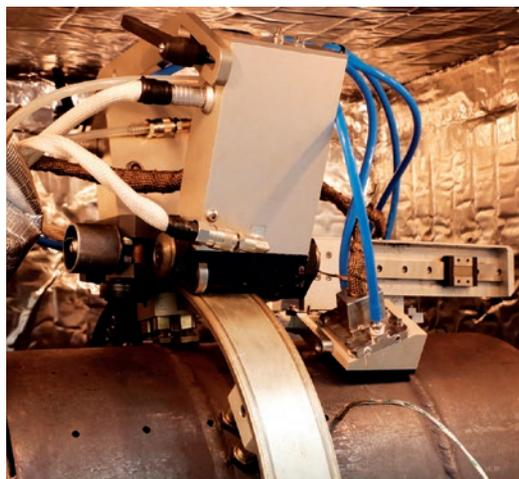
**O HI2TRUST** PERMITIU DESENVOLVER UM SISTEMA DE INSPEÇÃO DE SOLDADURAS COM OS COMPONENTES EM SERVIÇO A ALTA TEMPERATURA.
