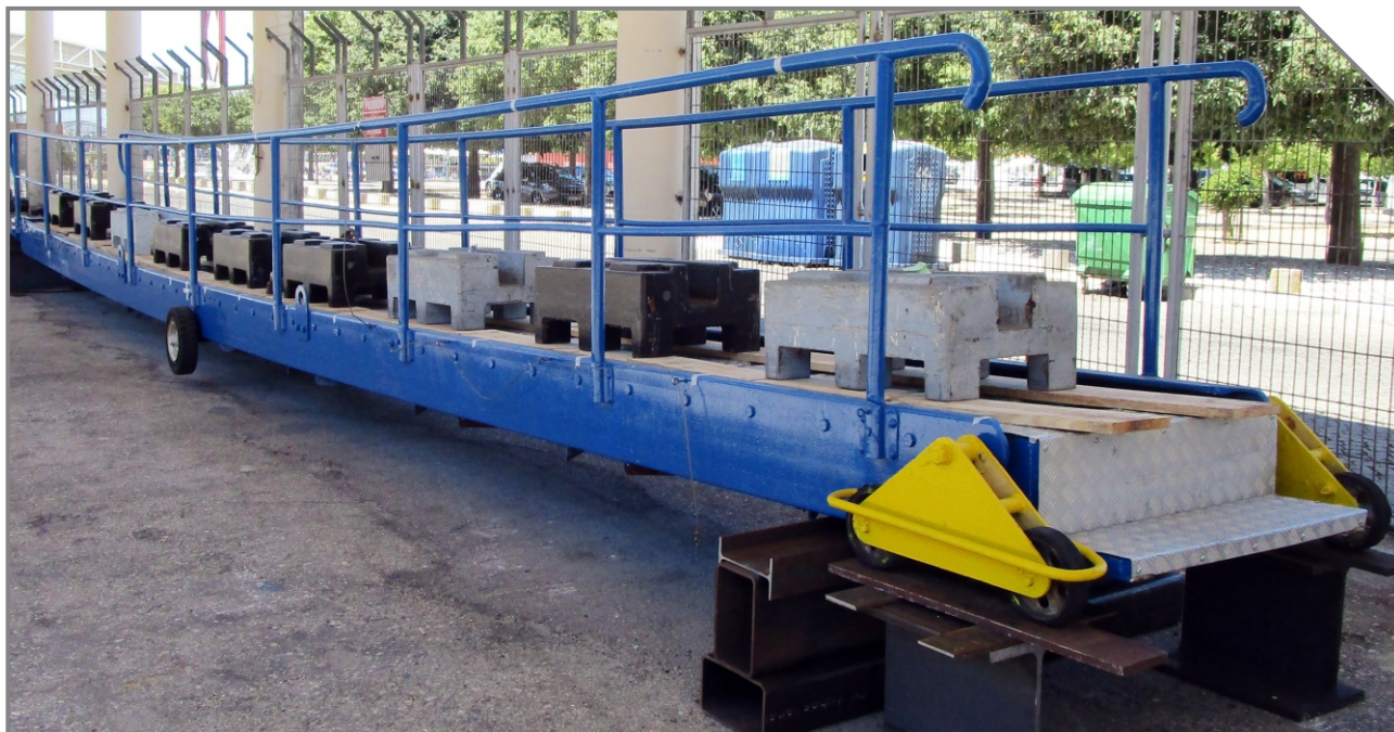
Ensaio de carga de passadiço
