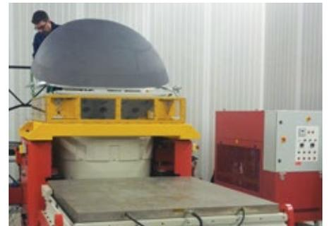
Assim, alterando a compactação das fibras de silício isolantes, foi possível mudar a rigidez deste “nariz do IXV”, fazendo com que o seu primeiro módulo de ressonância se afastasse da zona crítica dos 60 Hz.
