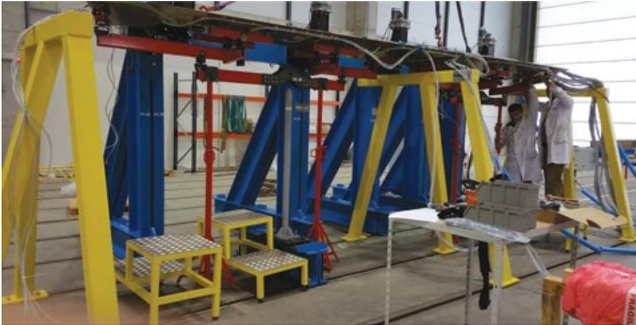
Um ensaio completamente novo, nunca antes efetuado em Portugal, operado por um complexo programa de controlo de hidráulicos, onde as variáveis introduzidas foram aos milhares, desde a configuração dos PIDs (*loop* de controlo por *feedback* Proportional Integral Derivate), todas as cargas que compunham os vários voos, as combinações
