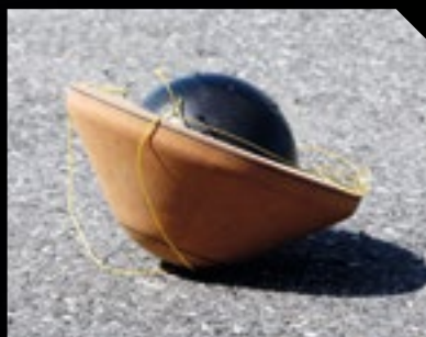
CÁPSULA DE REENTRADA ATMOSFÉRICA. OS TESTES DO DEMONSTRADOR DO ESCUDO DE PROTEÇÃO TÉRMICA E AMORTECIMENTO DE CHOQUES NA ATERRAGEM DESTA CÁPSULA EM MARTE FORAM REALIZADOS PELOS LABORATÓRIOS DO ISQ.
